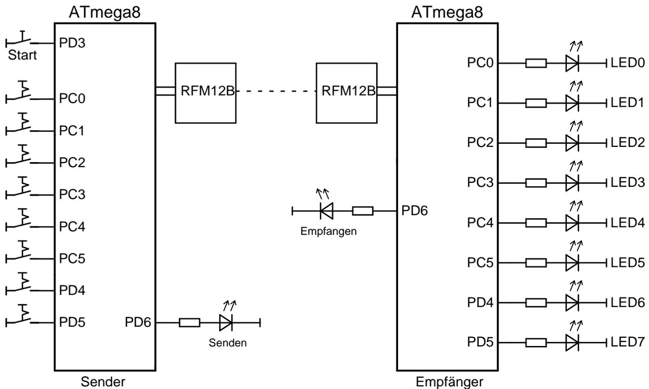
Wenn der Start-Taster betätigt wird (fallende Flanke) sollen die anliegenden 8-Bit-Daten gesendet und auf den LEDs am Empfänger angezeigt werden.
